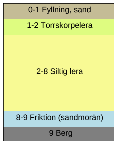
Figur 8 Tolkad jordlagerföljd i radhusområdet. Mäktigheterna kan variera, djupet till berg ökar norrut. Leran innehåller i vissa delar siltsikt.
